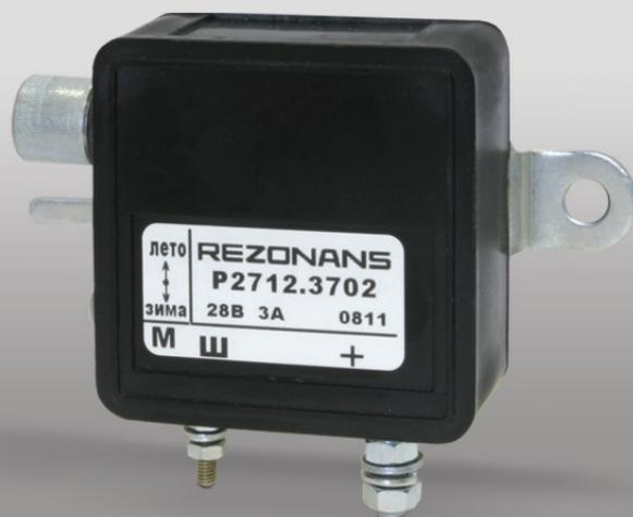
Предназначен для автоматического поддержания постоянного номинального напряжения 28В на выводах генератора при изменениях его частоты вращения и тока нагрузки.
