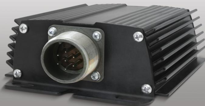
Предназначен для автоматического поддержания напряжения на выводах генератора при изменении частоты вращения и тока нагрузки путем регулирования тока, протекающего по обмотке возбуждения.
