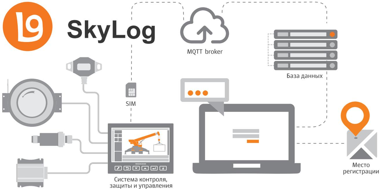
Web-сервис Skylog предназначен для удаленного мониторинга и диагностики подъемно-транспортных механизмов.
