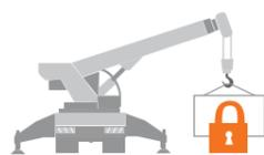
Сервис позволяет заблокировать работу крана в любой момент из личного кабинета пользователя Skylog. Также возможно настроить отложенную блокировку, задав дату блокировки. Может быть использован при сдаче крана в аренду или отгрузке без полной предоплаты конечному пользователю. Сервис может быть использован также для исключения повреждений крана и создания угрозы безопасности персонала на объекте при нештатных ситуациях.
